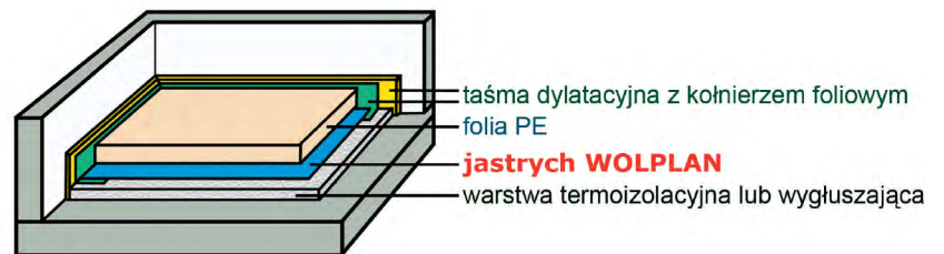
Jastrych na warstwie izolacyjnej
