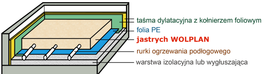
Jastrych ogrzewany ciepłą wodą
